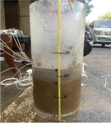
图2 有机玻璃筒及试验样品
